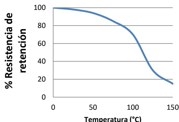
"Resistencia térmica" pruebas de resistencia realizadas en acero e vidrio. Ejemplares completamente curados y condicionados a temperatura durante 30 minutos antes de la prueba a temperatura.
