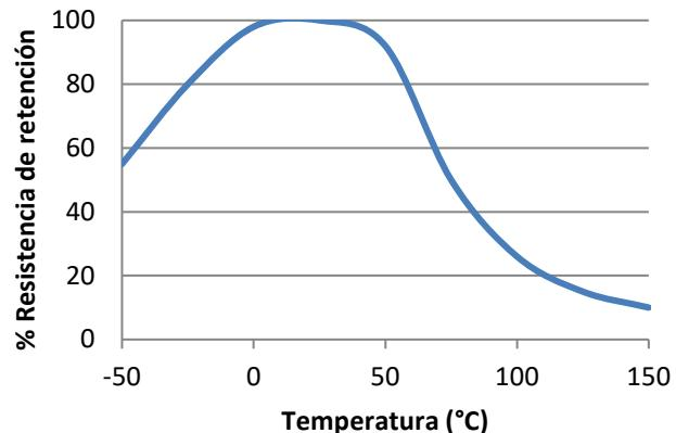
Resistencia térmica. pruebas de resistencia realizadas en acero. Curado de 24 horas a temperatura ambiente y condicionado a la temperatura de prueba durante 30 minutos.
