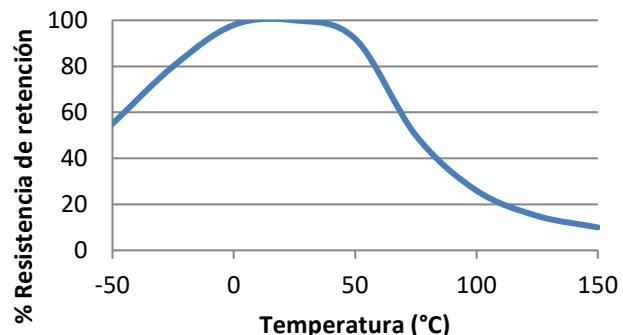
Resistencia térmica. pruebas de resistencia realizadas en acero. Curado de 24 hr a temperatura ambiental y condicionado a la temperatura de prueba durante 30 minutos.
