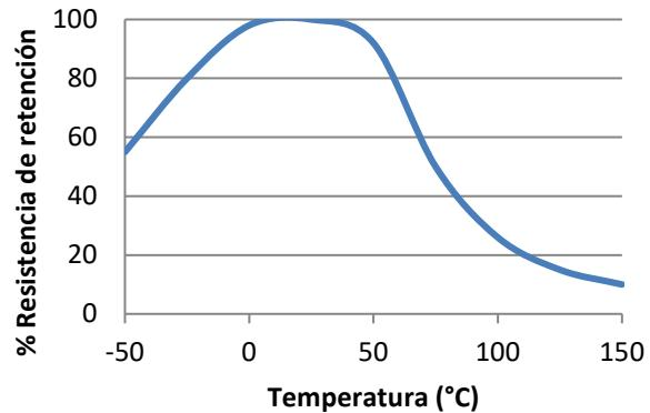
Resistencia térmica. pruebas de resistencia realizadas en acero. Curado de 24 hr a temperatura ambiente y condicionado a la temperatura de prueba durante 30 minutos.
