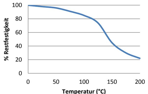
„Hitzebeständige“ Scherfestigkeitsversuche wurden auf Weichstahl durchgeführt. Vor den Testversuchen wurden die Teile über 30 Minuten auf der Testtemperatur gehalten.
