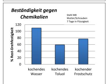
Dieses Produkt ist nicht geeignet für Verbindungen, die in direktem Kontakt mit Dampf oder reinem Sauerstoff stehen. Ein längerer Kontakt mit starken Säuren, Laugen oder stark polaren Lösungsmitteln ist zu vermeiden. Warnung: Das Produkt könnte u.U. einige Thermoplaste angreifen. Dem Anwender wird daher empfohlen, vor Gebrauch eine entsprechende Verträglichkeitsprüfung durchzuführen.
