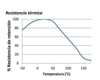
Resistencia térmica. pruebas de resistencia realizadas en acero. Curado de 24 horas a temperatura ambiental y condicionado a la temperatura de prueba durante 30 minutos.
